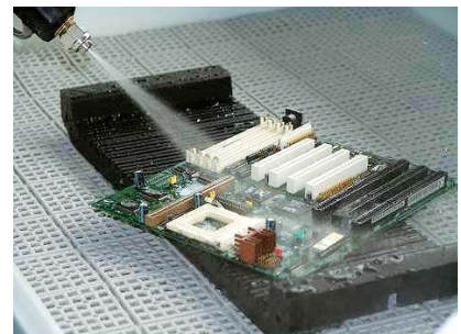
高圧スプレーによる汚染除去例
