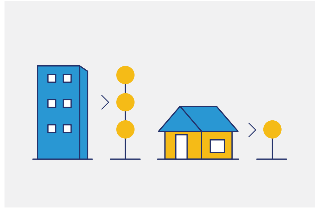
図9 多質点系モデル (MDOF) のイメージ
