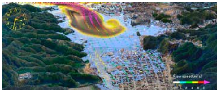
図1 2011年東日本大震災の津波による仙沼市の津波複合被害の再現計算（作成／東北大学災害科学国際研究所）
