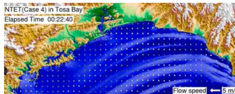
南海トラフ巨大地震の津波土砂移動シミュレーション(作成/東北大学災害科学国際研究所)
